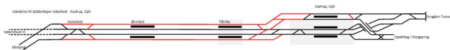
Figur 17. Skematisk sporlayout for en udvidelse af strækningen Kalvebod-Kastrup fra 2 til 4 spor samt etablering af yderligere 2 nye perroner på Kastrup, Tårnby og Ørestad. (Kreera AB, 2020)
