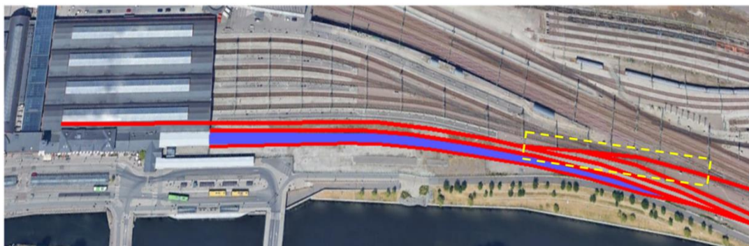
Figur 39. Översikt utformningsalternativ 1D, plattformen placeras utanför banhallen.
